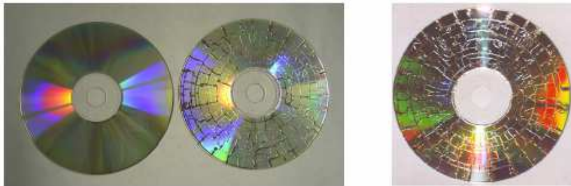
Obr. č. 3: CD před a po pokusu v mikrovlnné troubě
