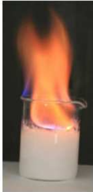
Obr. č. 10: Zapalování gelu špejlí a hoření „gelové svíčky“
