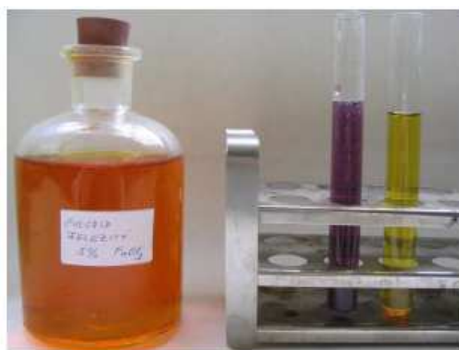
Obr. č. 6: Reakce kyseliny salicylové a vyrobeného acylpyrinu s roztokem chloridu železitého (acylpyrin se nechová jako fenol)
