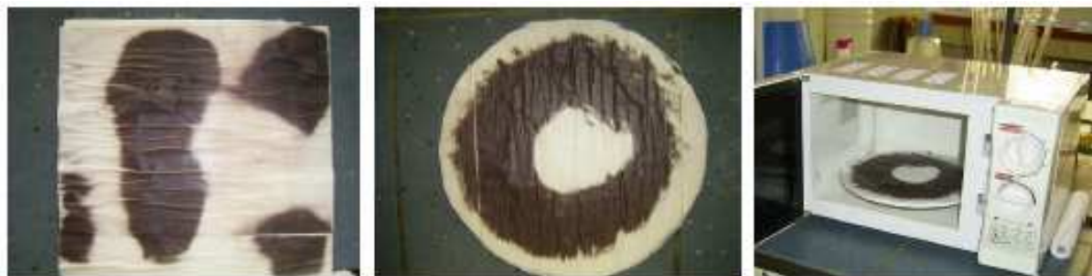
Obr. č. 2: Zkoumání intenzity mikrovlnného pole v troubě bez otočného talíře a s otočným talířem
