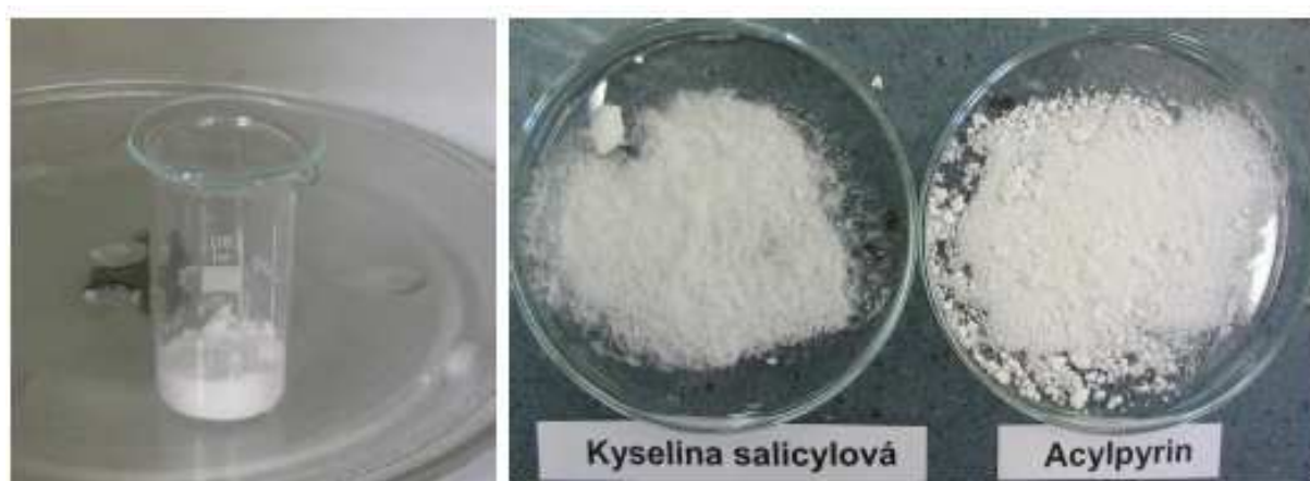
Obr. č. 5: Acylpyrin získaný v mikrovlnné troubě a porovnání vzhledu výchozí látky (kyseliny salicylové) a produktu (acylpyrin)
